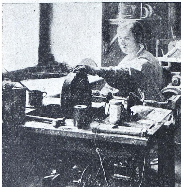
Рис. 8. Намотка секций для трансформатора высокого напряжения.
